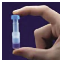
wciśnij tłoczek filtra do komory, czysty przesącz napętnia zbiornik od dołu do góry
